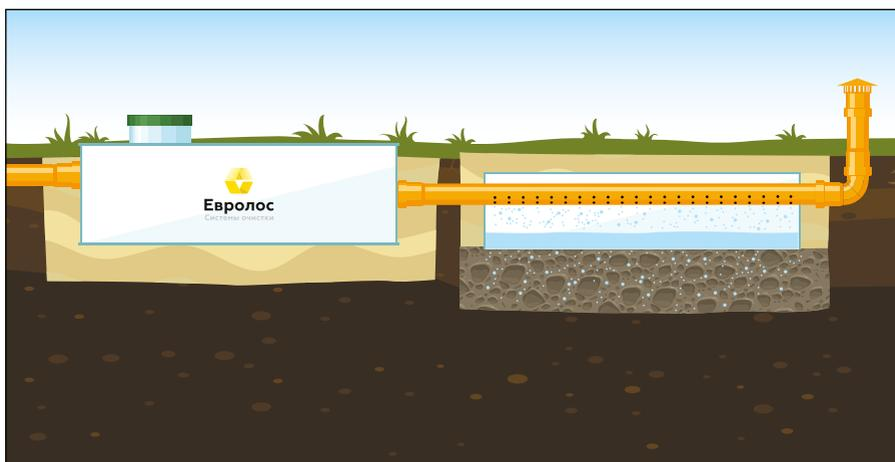
**Вариант 7.** Монтаж Септика «Удача» с частичным заглублением в грунт.
