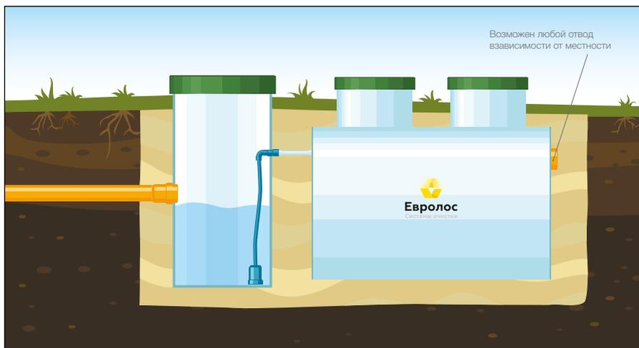
**Вариант 5.** Используется при выходе коллектора из здания на глубине до 1м по низу трубы.
