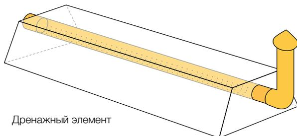
Дренажный элемент представляет собой ёмкость формы усеченной пирамиды без дна, располагающейся на подушке из щебня. Через всю длину проходит дренажная труба посредством которой самотеком сбрасывается вода.
